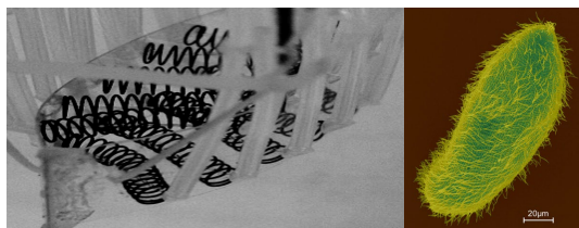
微生物運動を規範とした医用マイクロマシン (左: 試作機 右: 水棲微生物)
