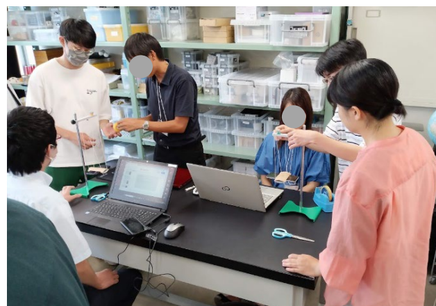
図 振り子の実験の様子 振り子のおもりかつ測定機器としてスマートフォンを設置している様子
